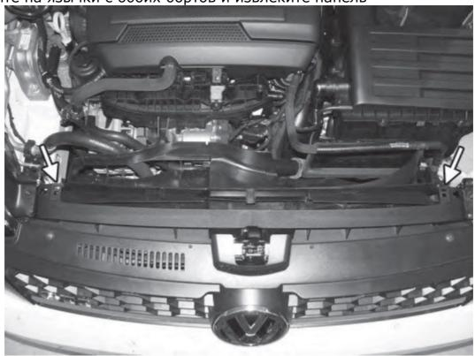
Отсоедините вакуумный шланг и трубку вторичного воздуха (если она у
