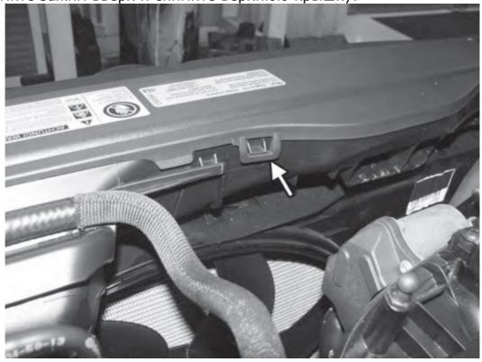
Аккуратно снимите шланг с охлаждающей жидкостью
