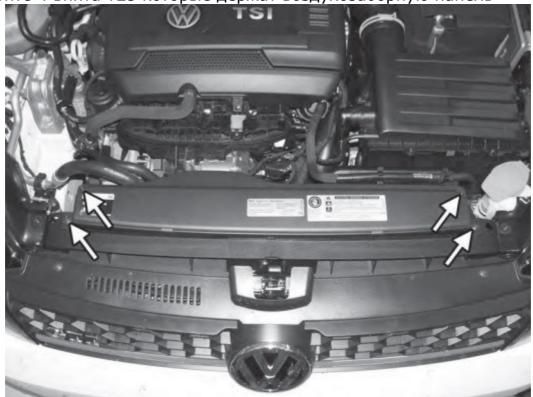
Поднимите зажим вверх и снимите верхнюю крышку.
