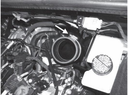
Далее установите трубу и демпферный патрубк, отрегулируйте наклон и глубину посадки, затяните хомуты.
